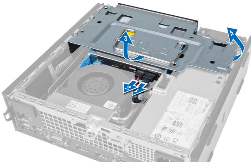
4. Desconecte os cabos de dados e de alimentação da parte de trás da unidade de disco rígido e remova o gabinete de unidade do computador.
