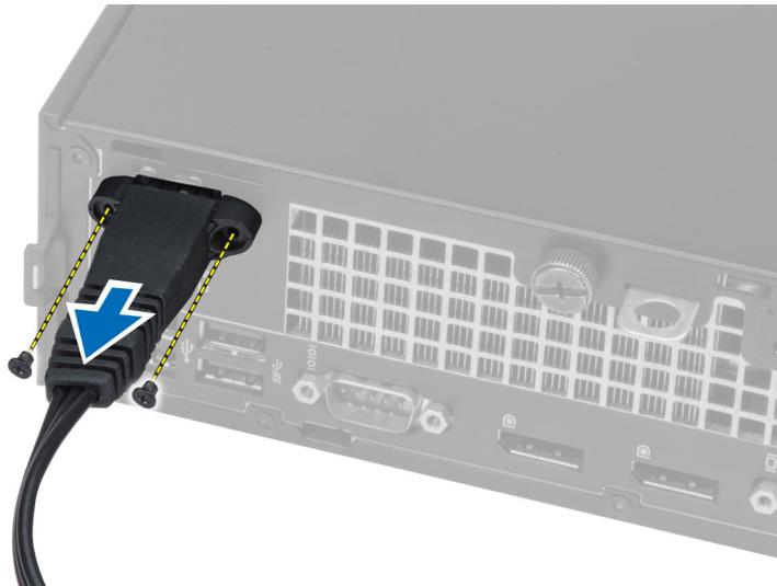
6. Deslize e remova o conector da antena do computador.
