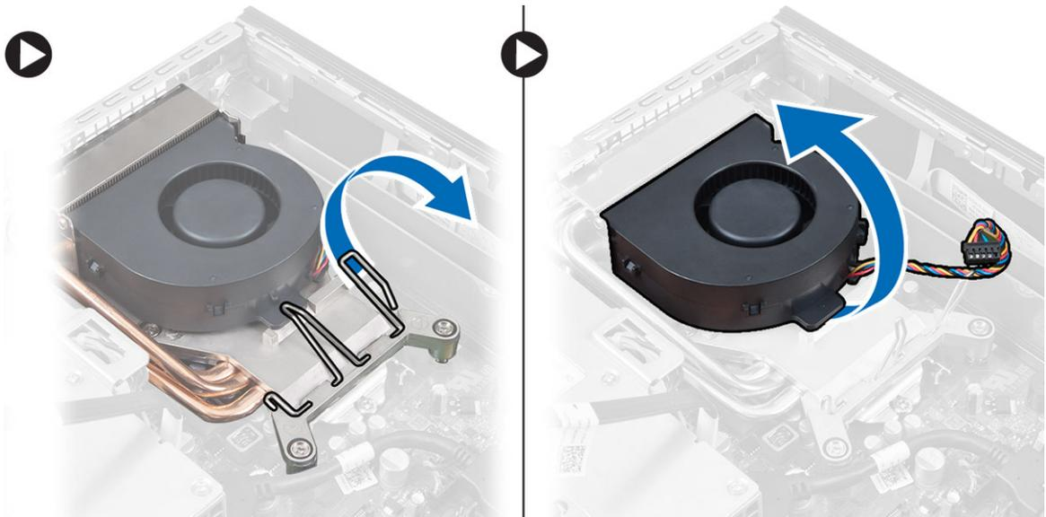
5. Solte os parafusos cativos e levante o conjunto do dissipador de calor e remova-o do computador.
