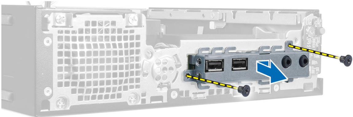
5. Remova os parafusos que fixam o painel de E/S ao suporte.
