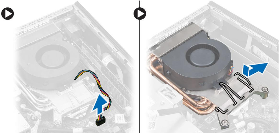
4. Gire a alavanca de liberação e levante a parte superior do ventilador.
