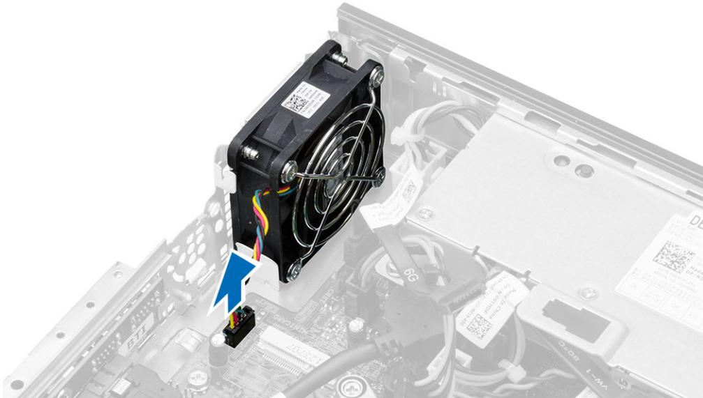
4. Remova os parafusos que prendem o ventilador ao chassi.
